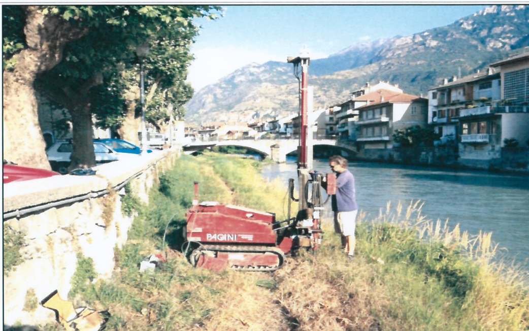
DPSH8 - Posizionamento penetrometro
