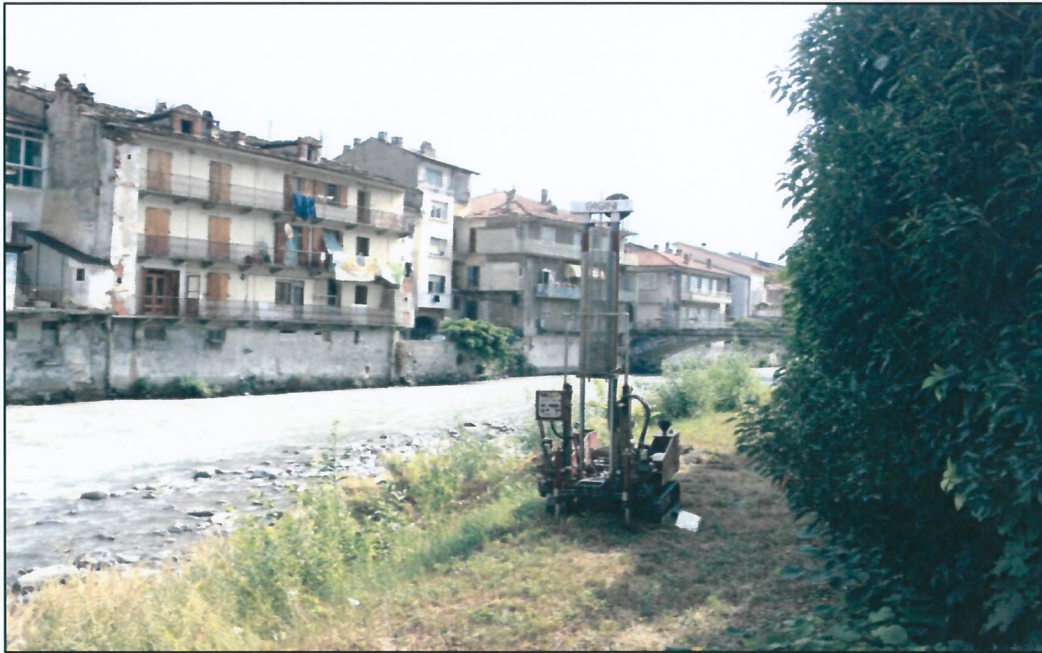
DPSH6 - Posizionamento penetrometro
