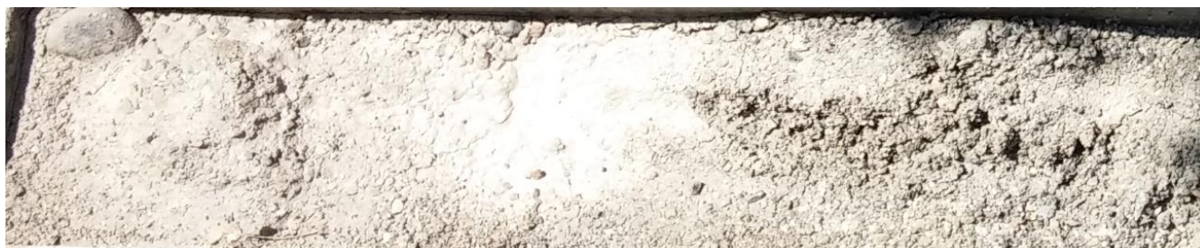
Fig. 14 – Foto dei terreni prevalentemente sabbiosi carotati nel corso del sondaggio S1
