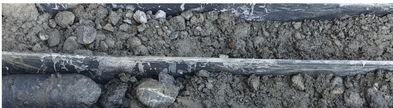
Fig. 13 – Foto dei terreni prevalentemente ghiaiosi carotati nel corso del sondaggio S3
