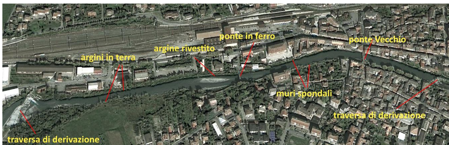
Fig. 4 – Opere idrauliche e attraversamenti della Dora Riparia nel tratto in esame
