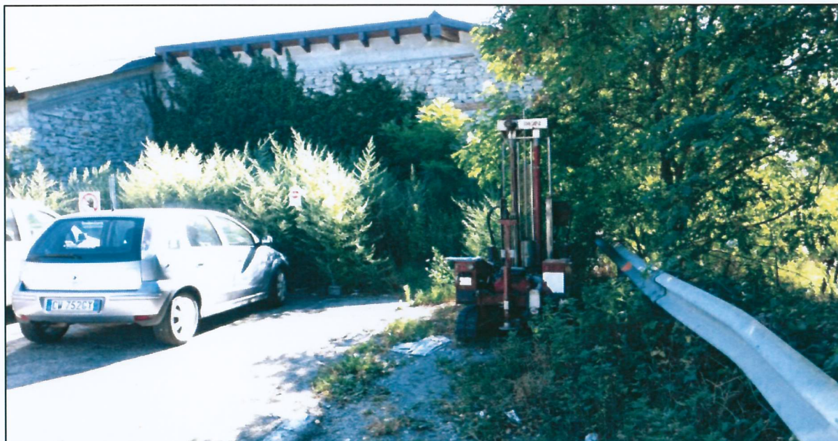
DPSH2 - Posizionamento penetrometro
