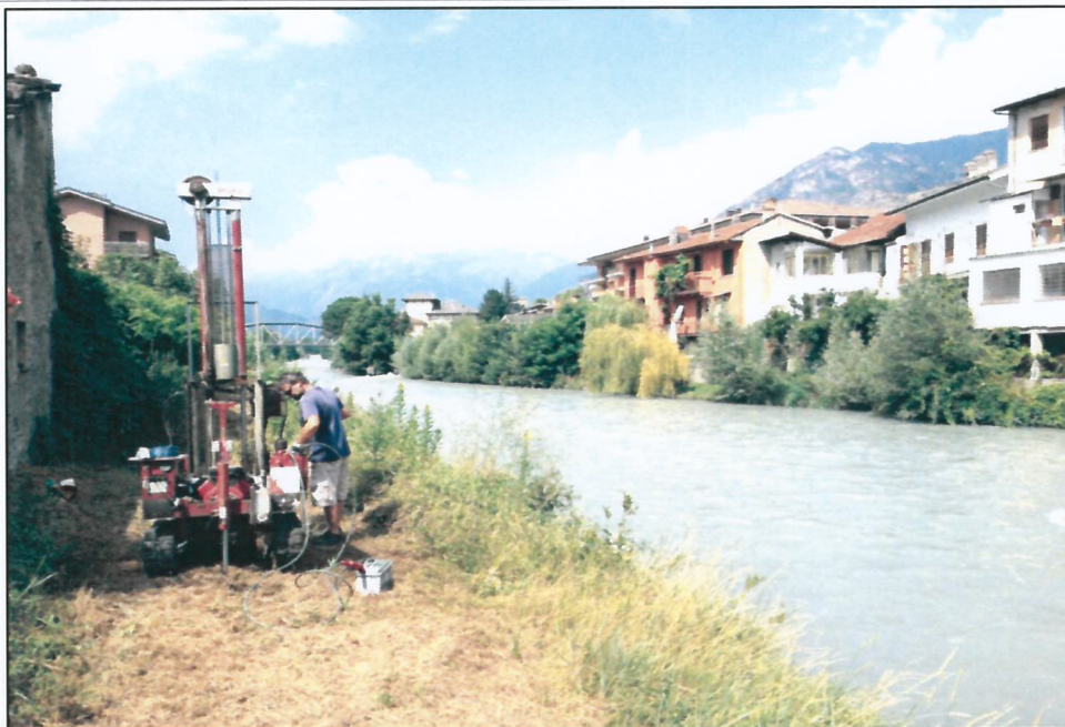
DPSH5 - Posizionamento penetrometro
