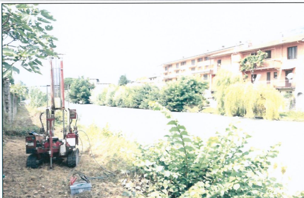
DPSH4 - Posizionamento penetrometro
