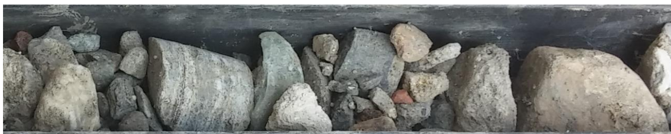
Fig. 12 – Foto dei terreni di riporto carotati nel corso del sondaggio S3
