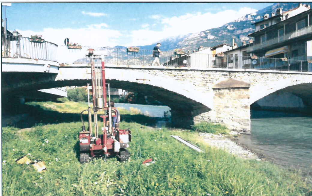
DPSH7 - Posizionamento penetrometro
